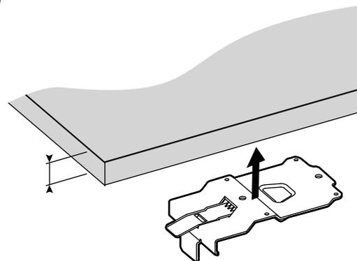
**ATTENTION:** les boulons de fixation ne sont pas inclus avec support. Utilisez boulons appropriés pour attacher à une surface de montage solide qui peut prendre en charge 50 lb (23 kg). Au minimum, la surface de montage doit être 1/2" (1,25 cm) épais bois et monter à l'aide de 4 vis de bois métalliques (M4 x 12 mm).
