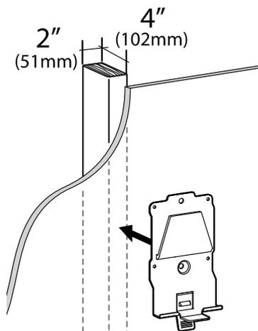
**ATTENTION:** les fixations fournies sont conçues pour une utilisation sur des poteaux de cloison en bois de 5 cm x 10 cm (2 po x 4 po) uniquement. Consultez un ingénieur afin de déterminer les types de fixation les mieux adaptés en fonction du matériau et de la charge appliquée.
